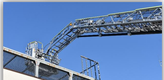
先端屈折式のため、フェンスなどの障害物を超えて接近することができます
